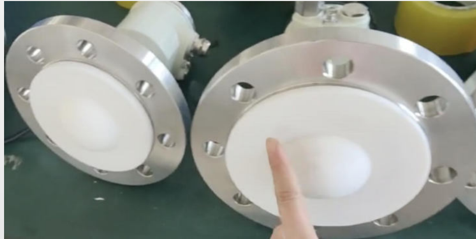
平面防腐 测量防腐液体，法兰DN40-DN200 120度常压，加散热片最高200度 (高温和高压不能并存)，常温可以1.6MPA
